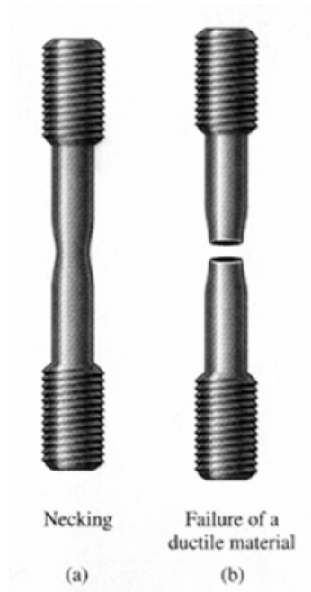
รูปที่ 4-2 ลักษณะการวิบัติของเหล็กเหนียว
