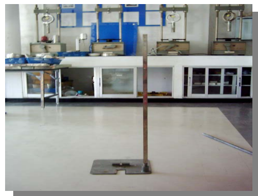
แผ่นเหล็กควบคุมการตอก
