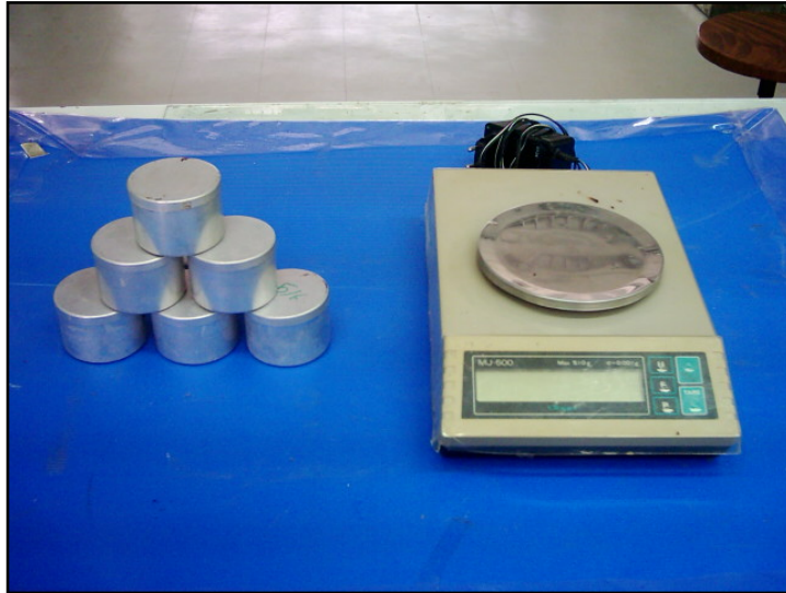
อุปกรณ์และเครื่องมือสำหรับการทดสอบหาปริมาณความชื้นในดิน
