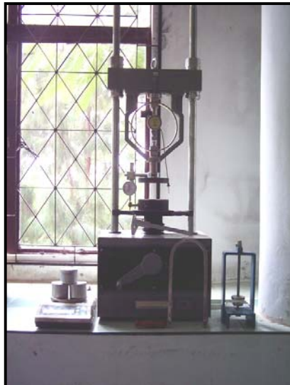
อุปกรณ์และเครื่องมือสำหรับการทดสอบแรงเฉือนแบบไม่ถูกจำกัด
