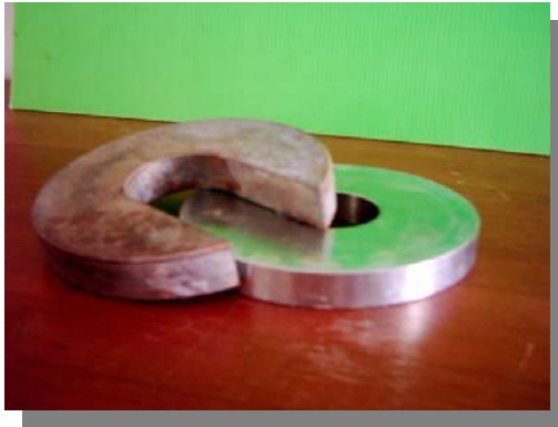
แผ่นน้ำหนัก (Surcharge Weight)
