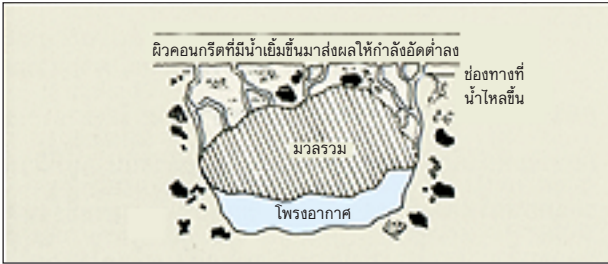
รูปที่ 7.6 การเยิ้มของคอนกรีตก่อให้เกิดช่องว่างเรียงตัวในทิศทางเดียว
