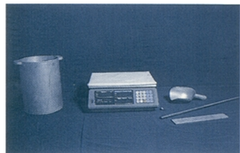
รูปที่ 7.17 อุปกรณ์ทดสอบหน่วยน้ำหนัก
