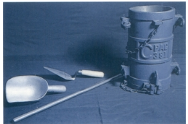
รูปที่ 9.6 อุปกรณ์ทำก้อนตัวอย่าง รูปทรงกระบอก
