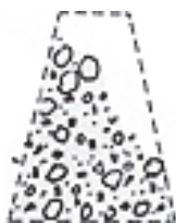
ยุบตัวแบบเฉือน (Shear Slump)
