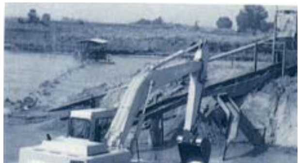
รูปที่ 3.7 เครื่องดูด ดูดทรายในแอ่งน้ำ
