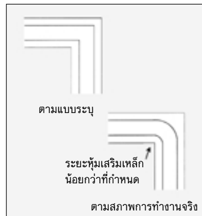
รูปที่ 16.3 การให้รายละเอียดมีความสำคัญต่อความทนทานของโครงสร้างคอนกรีตเสริมเหล็ก
