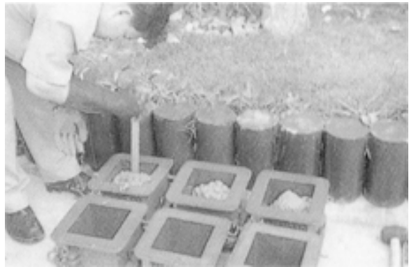
รูปที่ 19.4 การทำก้อนตัวอย่างเพื่อควบคุมคุณภาพ
