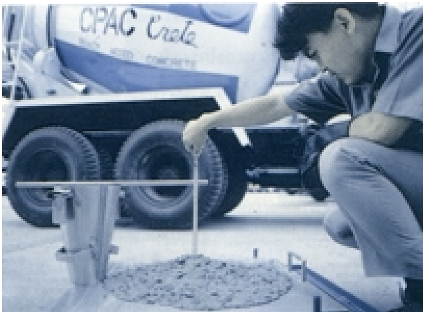
รูปที่ 7.4 คอนกรีตที่เหลวมากด้วยน้ำยาผสมคอนกรีตไม่มีการแยกตัว
