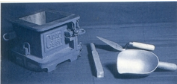
รูปที่ 9.5 อุปกรณ์ทำก้อนตัวอย่าง รูปทรงลูกบาศก์
