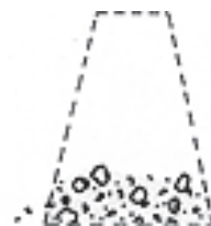
ยุบตัวแบบล้ม (Collapse Slump)
