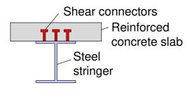
คานเหล็กยึดติดกับพื้นคอนกรีต การส่งผ่านแรงเฉือน อาศัยอุปกรณ์เชิงกล
