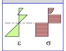
ในกรณีที่รอยต่อรับแรงเฉือนไม่สามารถรับแรงเฉือนทั้งหมดที่ เกิดขึ้นได้ หน้าตัดคานวัสดุผสมจะมีพฤติกรรมเสมือนมีค่า โมดูลัสหน้าตัดประสิทธิผลลดลง
