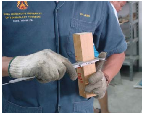
5.1.4 ทำการวัดความยาว (Length) ของชิ้นไม้ทดสอบ เช่นเดียวกันการวัดขนาดภาคตัวขวาง
