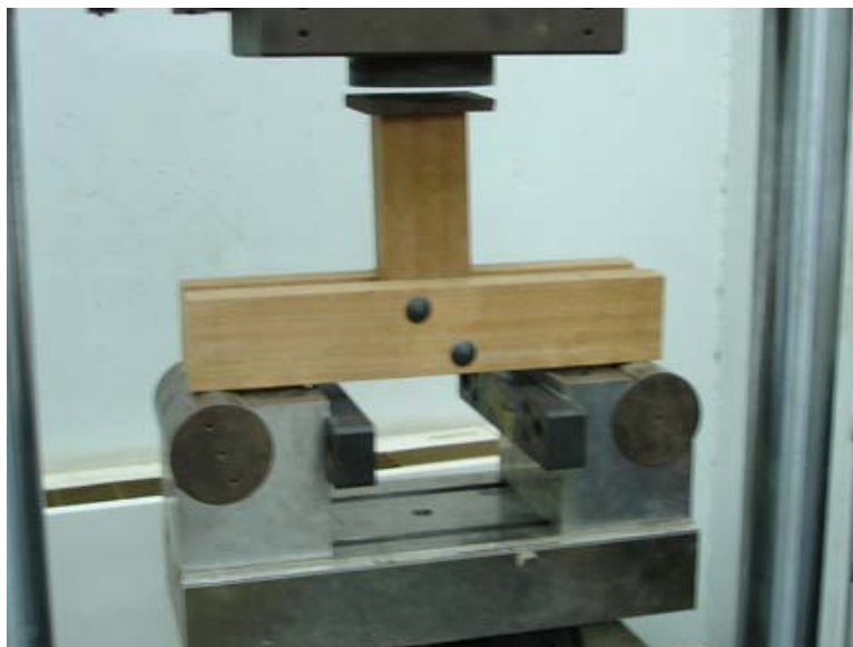
5.2.6 เคลื่อนหัวกดมาแตะสัมผัส จากนั้นปรับเกจวัดการเคลื่อนที่(Dial Gauge) และค่าของแรงที่เครื่องทดสอบ Universal Testing Machine ให้อยู่ตำแหน่งเลขศูนย์
