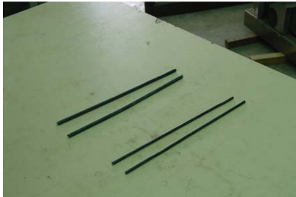
4.4 เหล็กเส้นกลมขนาดเส้นผ่าศูนย์กลาง 9 และ 12 มิลลิเมตร อย่างละ 2 ตัวอย่าง
