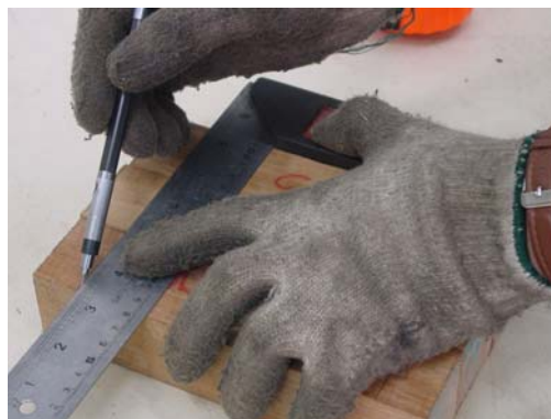
5.1.5 ทำการกำหนดพิกัดความยาว (Gauge Length) ที่ชิ้นไม้ทดสอบให้มีพิกัดความยาวประมาณ 6 นิ้ว
