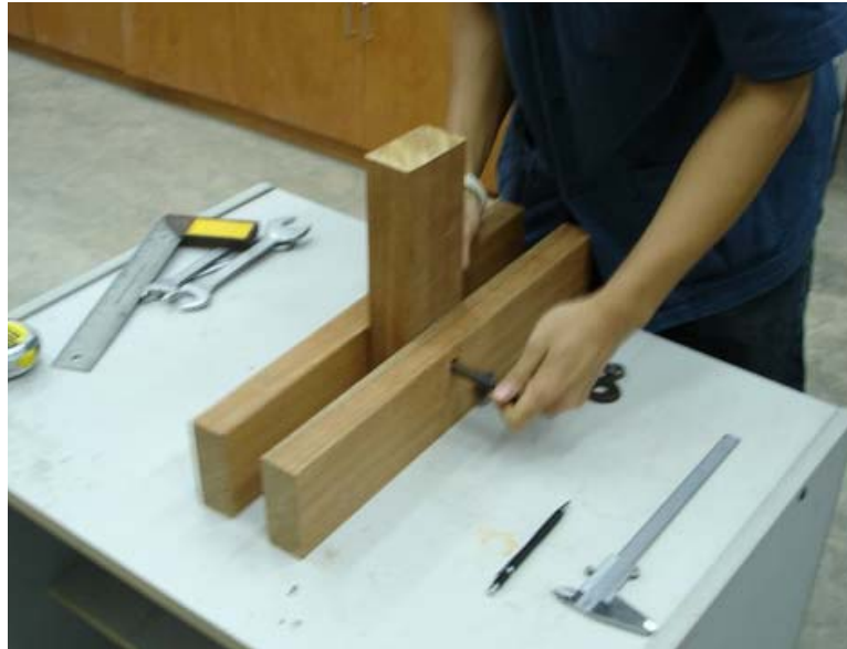
5.2.5 นำชิ้นตัวอย่างที่พร้อมแล้วขึ้นวางบน Support บนแท่นเครื่อง
