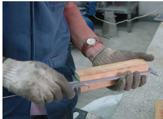
5.1.5 ทำการกำหนดพิกัดความยาว (Gauge Length) ที่ชิ้นไม้ทดสอบให้มีพิกัดความยาวประมาณ 6 นิ้ว
