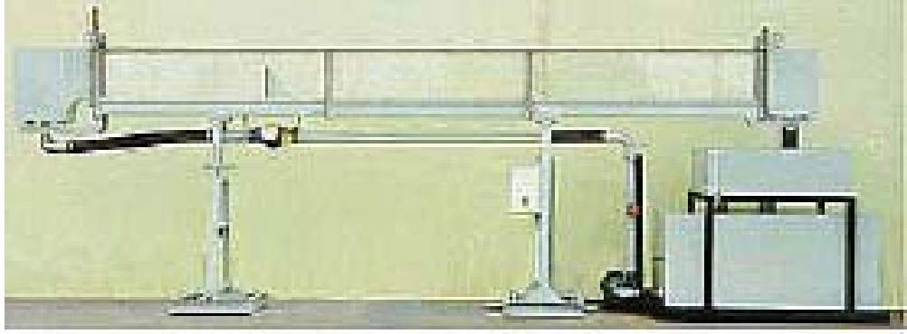
ภาพที่ 10.1 ชุดทดสอบการไหลสม่ำเสมอในทางน้ำเปิด
