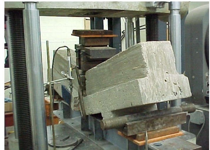
คานคอนกรีตล้วน
