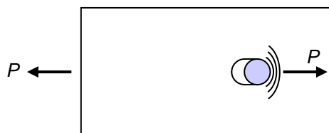
รูปที่ 11.6 การวิบัติโดยแรงแบกทานจากสลักเกลียว
