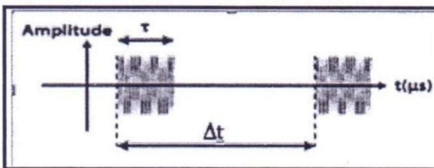
On s'intéresse à un radar qui émet des impulsions de fréquence  $\nu = 2,9 \text{ GHz}$ , de durée  $\tau = 1 \mu\text{s}$ , espacées d'une durée  $\Delta t = 100 \mu\text{s}$ .
