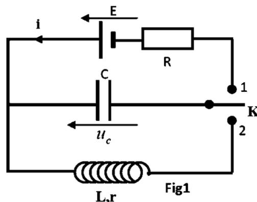
Lorsque le régime permanent est atteint, on bascule l'interrupteur à la position 2 à un instant que l'on considère comme nouvelle origine des temps, pour décharger le condensateur dans une bobine de coefficient d'inductance  $L = 0,2 H$  et de résistance  $r$ .
