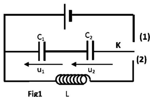
1. On place l'interrupteur  $K$  dans la position (1), alors les deux condensateurs se chargent instantanément.
