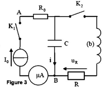
On ferme l'interrupteur  $K_1$  à l'instant de date  $t=0$ . L'intensité du courant indiquée par le microampèremètre est  $I_0 = 4\mu A$ .
