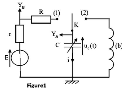
On fixe la capacité du condensateur sur la valeur  $C_0 = 5\mu F$ . A un instant de date  $t = 0$ , on place l'interrupteur  $K$  en position (1).
