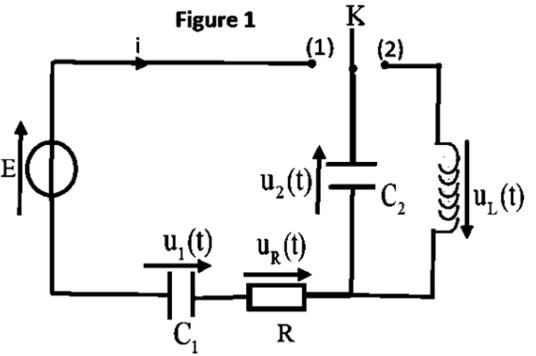
Lorsque le régime permanent est établi, on bascule l'interrupteur  $K$  à la position (2) à un instant pris comme nouvelle origine des dates ( $t = 0$ ).
