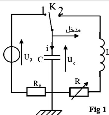
1. A la fin de la charge du condensateur, Ahmed règle la résistance R sur la valeur  $R_1 = 0$ . A l'instant  $t=0$ , il bascule l'interrupteur K à la position (2), Il obtient alors la courbe représentée par la figure 2.
