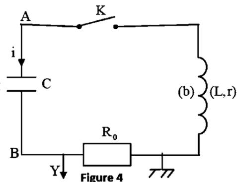
On ferme le circuit et on visualise la tension  $u_{R0}(t)$  aux bornes du conducteur ohmique. On observe des oscillations pseudo-périodiques.
