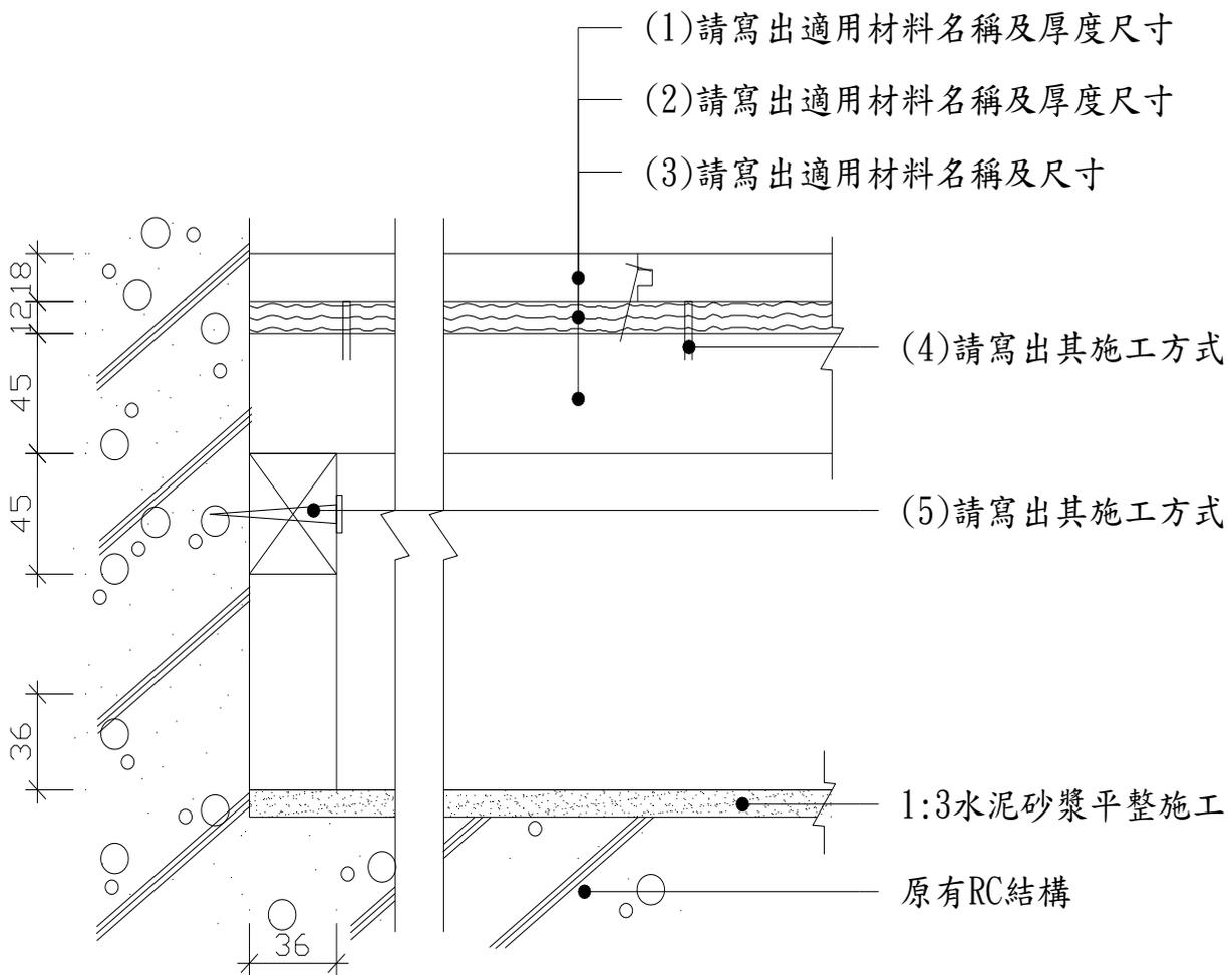
高架實木地板施工大樣圖 單位:mm
