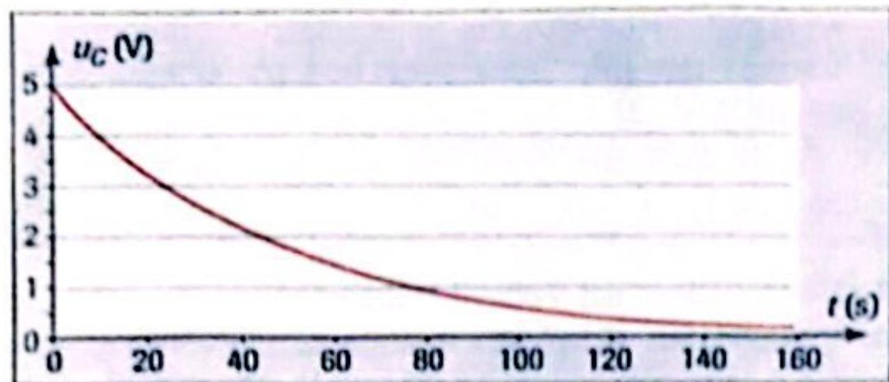
1- Montrer que l'équation différentielle régissant les variations de la tension  $u_c$  aux bornes du condensateur en fonction du temps est de la forme :  $u_c(t) + RC \frac{du_c}{dt}(t) = 0$
