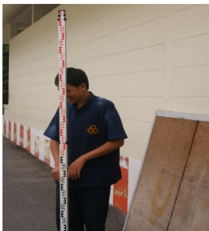
รูปที่ 1.10 แสดงการส่องกล้องระดับหาตำแหน่งทางตั้ง
