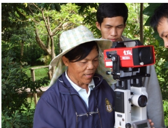
รูปที่ 1.19 แสดงการประกอบกล้องวัดมุมกับ EDM. เพื่อเก็บรายละเอียด
