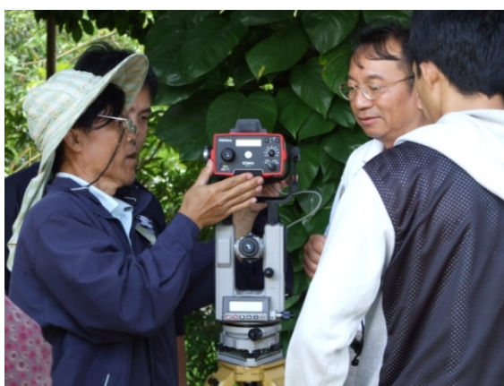
รูปที่ 2.2 แสดงการติดตั้งเครื่องวัดระยะอิเล็กทรอนิกส์กับกล้องวัดมุม
