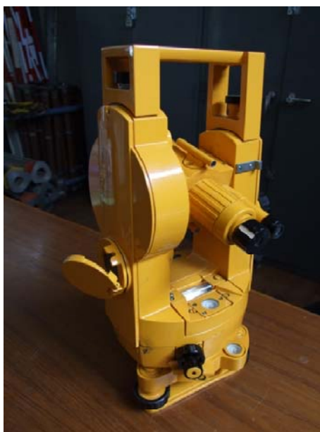
รูปที่ 5.2 แสดงกล้องวัดมุมแบบอ่านค่าโดยระบบแสง
