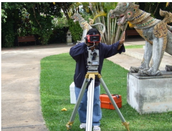
รูปที่ 2.3 แสดงการเล็งเป้าสะท้อนสัญญาณวัดระยะ
