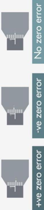
+ve zero error -ve zero error No zero error
