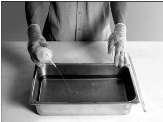
รูปที่ 3 การเติมสารละลายแบเรียมคลอไรด์ลงในน้ำล้างตัวอย่าง
