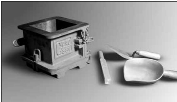
รูปที่ 10 อุปกรณ์ทำก้อนตัวอย่าง รูปทรงลูกบาศก์
