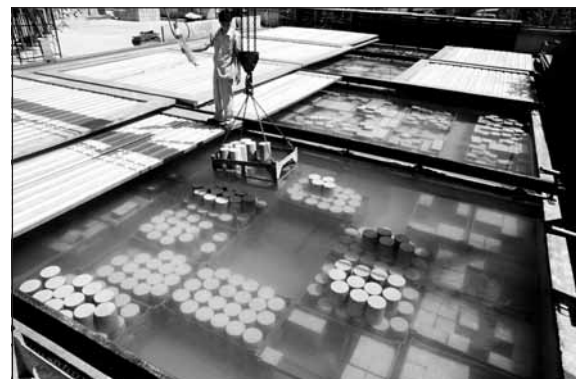
รูปที่ 2 การบ่มก้อนตัวอย่างคอนกรีต
