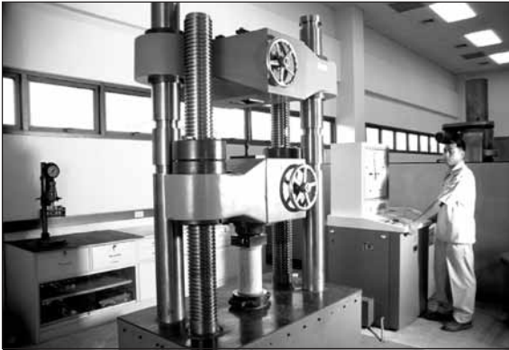
รูปที่ 3 การกดก้อนตัวอย่างคอนกรีตด้วยเครื่องทดสอบ
