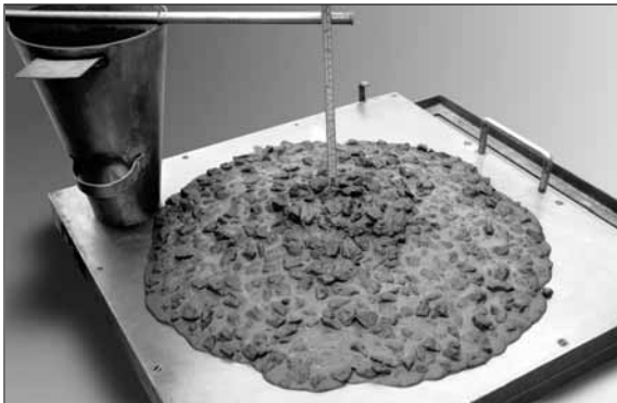
รูปที่ 4 การวัดค่ายุบตัว
