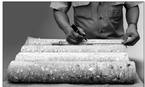
รูปที่ 8 ก้อนตัวอย่างที่ได้จากการเจาะคอนกรีตในโครงสร้าง
