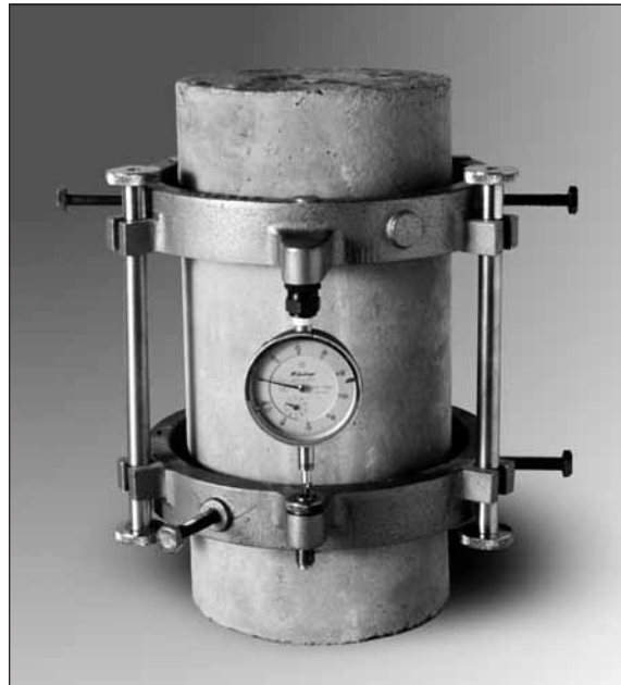
รูปที่ 4 ก้อนตัวอย่างที่ได้รับการติดตั้ง Compressometer
