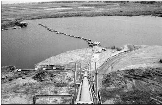
รูปที่ 4 ท่อส่งลำเลียงทรายจากเรือเข้าสู่ Feedbox
