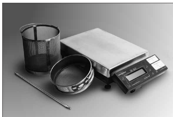
รูปที่ 7 อุปกรณ์หาค่าความถ่วงจำเพาะของมวลรวมหยาบและการดูดซึมน้ำ
