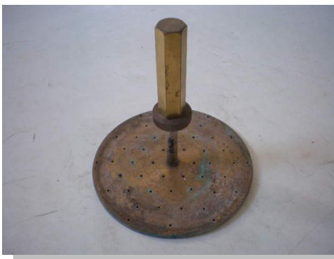
รูปที่ 8.6 แสดงแผ่นวัดการบวมตัว รูปที่ 8.7 แสดงมาตรวัดการบวมตัว ภาพโดย : มานิต ช่วงาน ห้องปฏิบัติการปรุฬพิภลศษษตร วิทยาลัยเทคนิคเชียงใหม่ มี.ย. 2552
