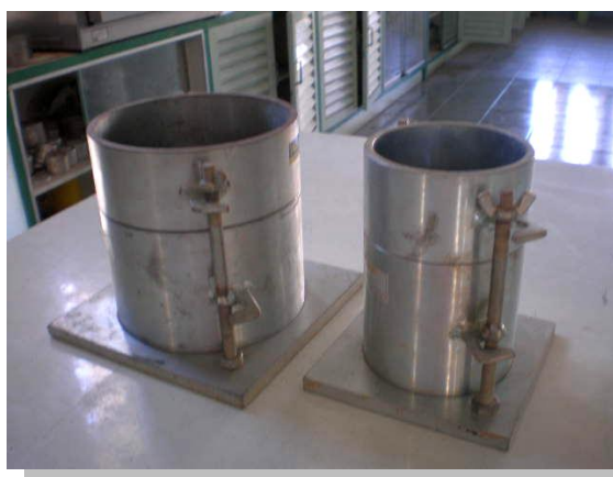
รูปที่ 7.3 แสดงโมล เส้นผ่าศูนย์กลางขนาด 10.16 ซม. และขนาด 15.24 ซม.
