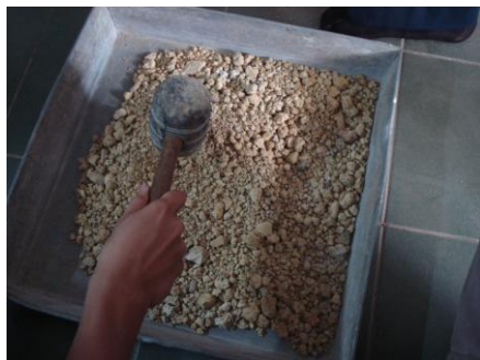
รูปที่ 7.11 แสดงการทุบดินให้แยกออกจากกัน รูปที่ 7.12 แสดงการบดอัดดินบนพื้นที่เรียบแข็ง
