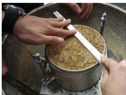
รูปที่ 7.13 แสดงการปาดดินส่วนเกินออก รูปที่ 7.14 แสดงการชั่งเพื่อหาน้ำหนักของดินในโมล
