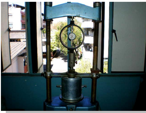
รูปที่ 8.4 แสดงเครื่องทดสอบแรงกดพร้อมแท่งกด รูปที่ 8.5 แสดงแผ่นน้ำหนกวงแหวน ภาพโดย : มานิต ช่วงาน ห้องปฏิบัติการปรุฬพิภลศษษตร วิทยาลัยเทคนิคเชียงใหม่ มี.ย. 2552
