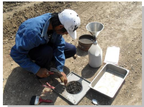
รูปที่ 9.6 แสดงการวางแผ่นฐานและตอกตะปูที่มุม รูปที่ 9.7 แสดงการสกัดดินตรงกลางแผ่นฐานรอง ภาพโดย : มานิต ช่วยงาน ก.ค. 2552
