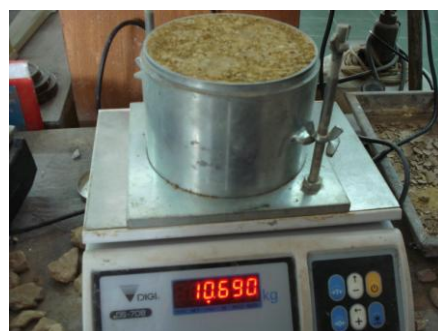
รูปที่ 7.13 แสดงการปาดดินส่วนเกินออก รูปที่ 7.14 แสดงการชั่งเพื่อหาน้ำหนักของดินในโมล
