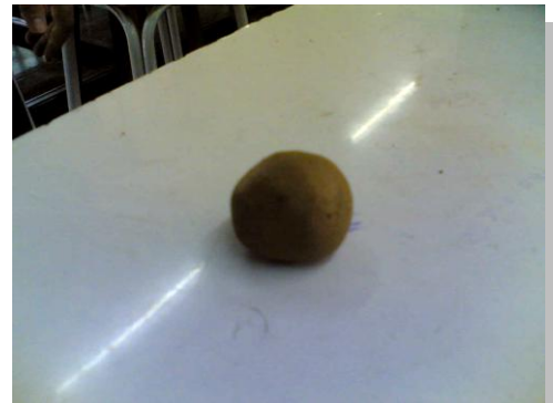
รูปที่ 4.13 แสดงดินที่ปั้นคลึงจนกลม
