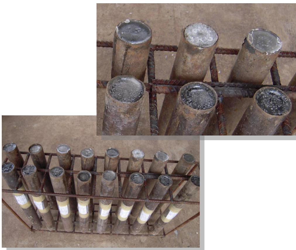
รูปที่ 10.10 แสดงการเก็บตัวอย่างดินด้วยกระบอกลูกกลิ้งบาง
