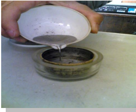
รูปที่ 4.23 แสดงการใส่ปรอทลงใน Shrinkage Dish รูปที่ 4.24 แสดงการใช้แผ่นกระจกที่มีสามขา กดดิน
