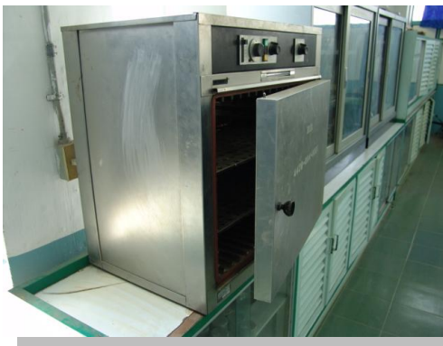
รูปที่ 5.7 แสดงเตาอบ 110 \pm 5 องศาเซลเซียส รูปที่ 5.8 แสดงเครื่องชั่งอ่านได้ถึง 0.01 กรัม ภาพโดย : มานิต ช่วรงาน ห้องปฏิบัติการปฐพีกลศาสตร์ วิทยาลัยเทคนิคเชียงใหม่ มี.ย. 2552
