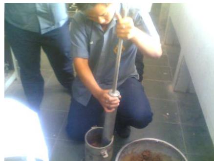
รูปที่ 7.11 แสดงการทุบดินให้แยกออกจากกัน รูปที่ 7.12 แสดงการบดอัดดินบนพื้นที่เรียบแข็ง
