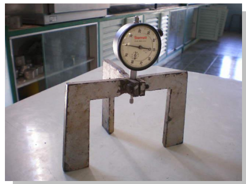
รูปที่ 8.6 แสดงแผ่นวัดการบวมตัว รูปที่ 8.7 แสดงมาตรวัดการบวมตัว ภาพโดย : มานิต ช่วงาน ห้องปฏิบัติการปรุฬพิภลศษษตร วิทยาลัยเทคนิคเชียงใหม่ มี.ย. 2552
