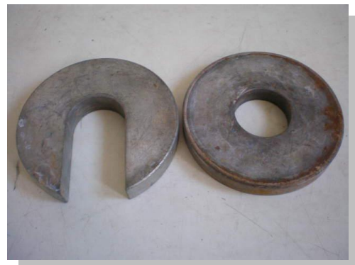
รูปที่ 8.4 แสดงเครื่องทดสอบแรงกดพร้อมแท่งกด รูปที่ 8.5 แสดงแผ่นน้ำหนกวงแหวน ภาพโดย : มานิต ช่วงาน ห้องปฏิบัติการปรุฬพิภลศษษตร วิทยาลัยเทคนิคเชียงใหม่ มี.ย. 2552
