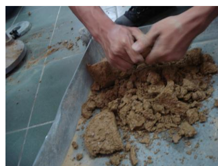
รูปที่ 7.15 แสดงการดันดินออกจากโมล รูปที่ 7.16 แสดงผสมน้ำเพิ่มกับดินเดิมและดินในโมล
