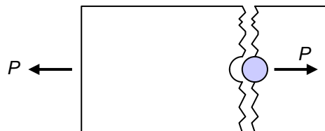
รูปที่ 11.5 การวิบัติโดยแรงดึงของแผ่นเหล็ก
