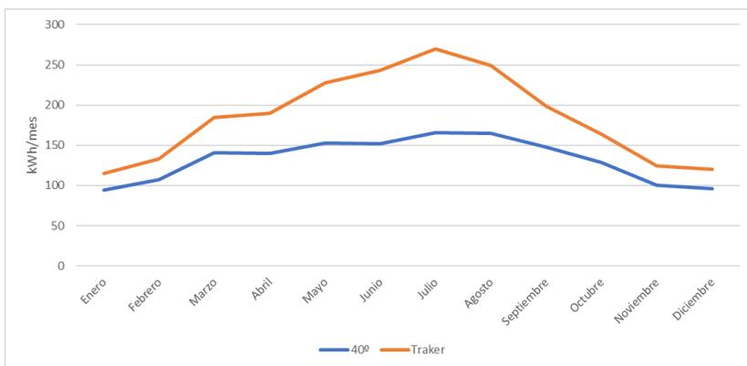
*Ilustración 40. Trackers vs estructura fija*
