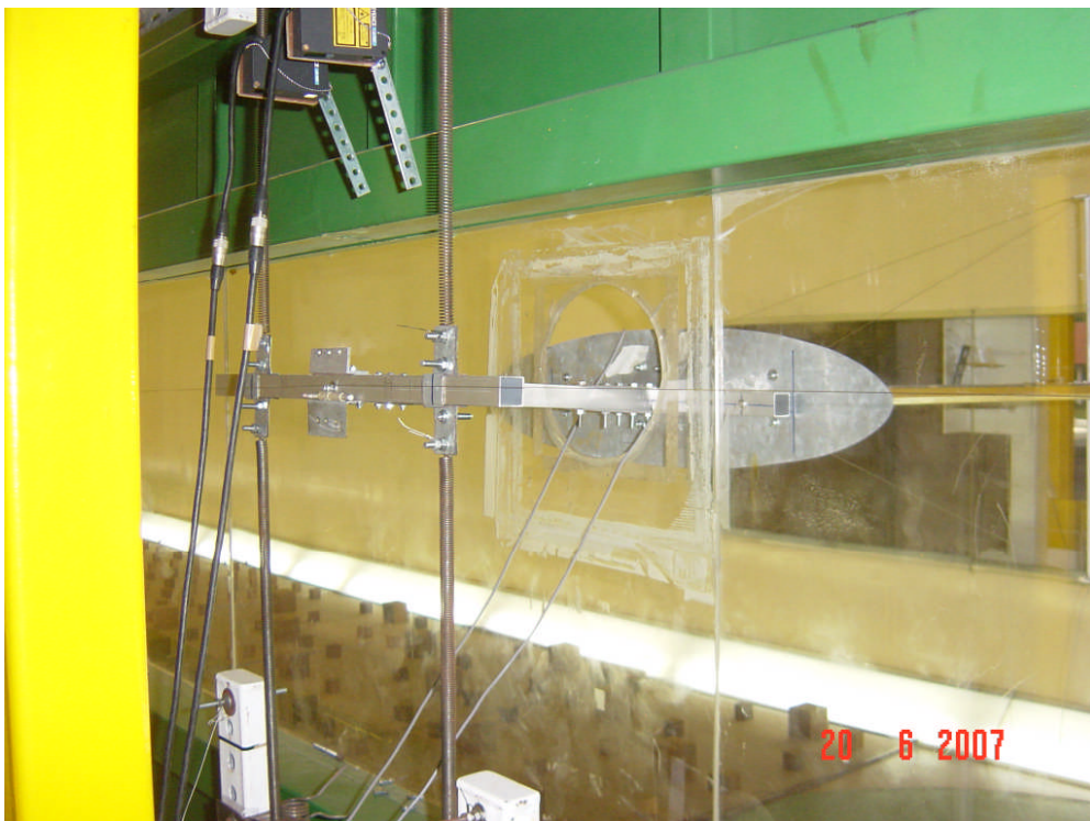
ข. แบบจำลองหน้าตัดสะพานที่ติดตั้งอยู่บนสปริง เพื่อจำลองคุณสมบัติทางด้านพลศาสตร์
