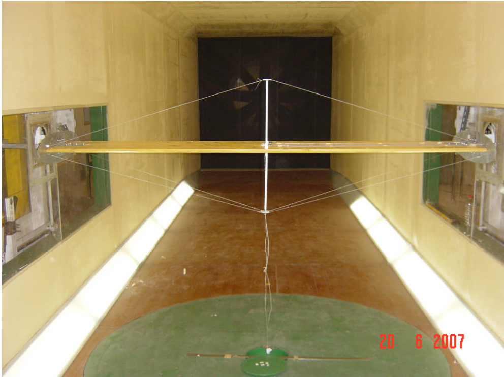
ก. แบบจำลองหน้าตัดสะพานบางส่วนในอุโมงค์ลม
