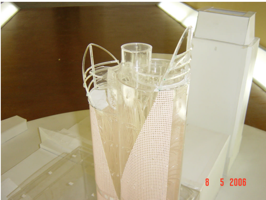
ข. แบบจำลองแข็ง ที่ติดตั้งท่อส่งแรงดัน เพื่อวัดความดันลมที่จุดต่างๆ ของผนัง โดยรอบอาคาร
