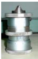
รูปที่ 3.1 แสดงโหลดเซลล์ (Load cell) สำหรับใช้ในการวัดแรงปฏิกิริยาที่เกิดขึ้นที่จุดรองรับของคาน
