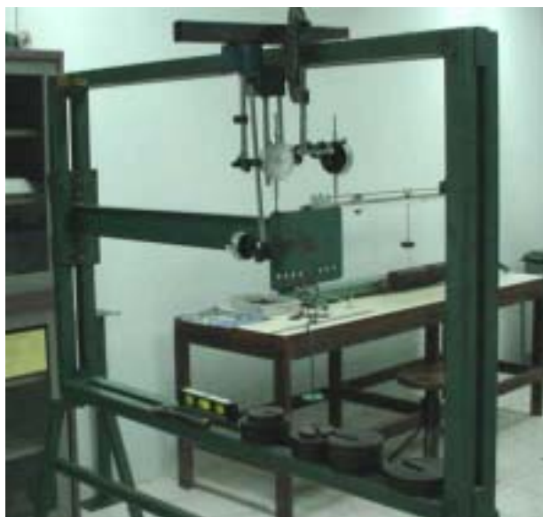
รูปที่ 8.5 แสดงชุดเครื่องมือการศึกษาพฤติกรรมของคานผนังบางแบบเปิด
