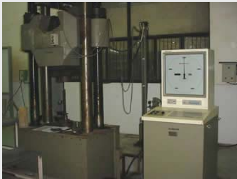
รูปที่ 2.2 แสดงเครื่องมือให้แรง Universal Testing Machine
