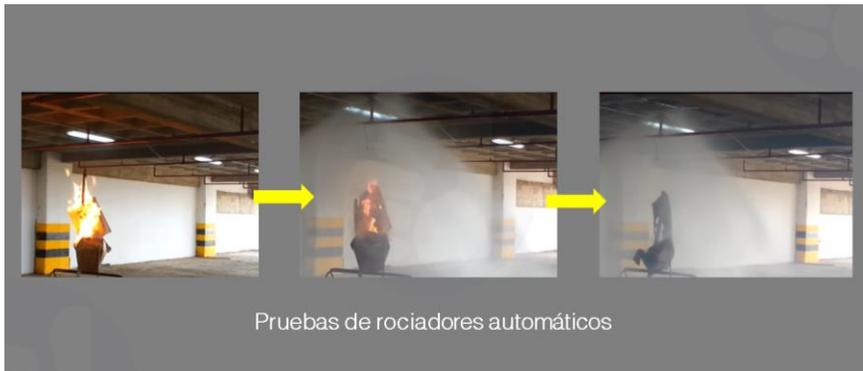
En la imagen se puede ver un ejemplo de una prueba real del Sistema de Rociadores Automáticos.
