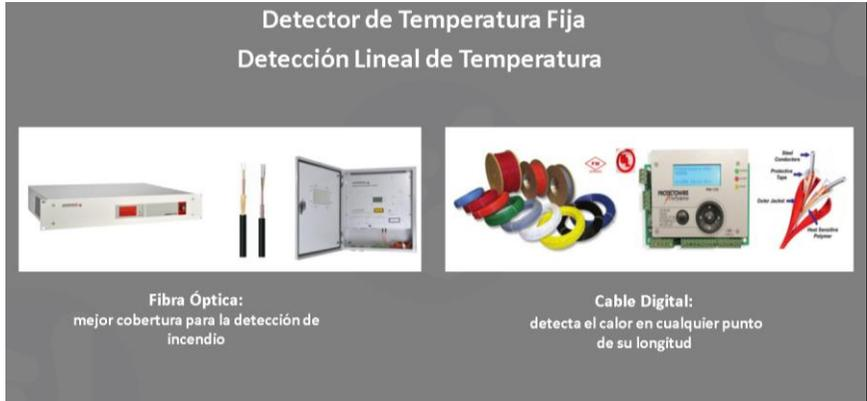
**Otro detector de temperatura fija es un detector de línea.**
