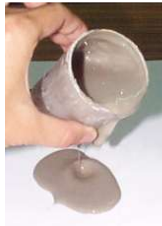
รูปที่ 2-20 เมื่อทิ้งไว้โดยไม่มีรบกวนจะมี Shear Strength เพิ่มขึ้นแต่เมื่อเขย่าหรือกวนกำลังจะลดลงจนกระทั่งไหลได้
