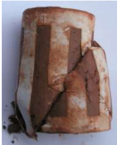
รูปที่ 8-17 ตัวอย่างดินเมื่อมีแรงกระทำตามแนวแกนแต่การวิบัติเป็นแบบเฉือน
