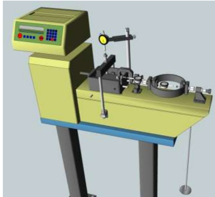
รูปที่ 8-64 เครื่องมือทดสอบ Direct shear
