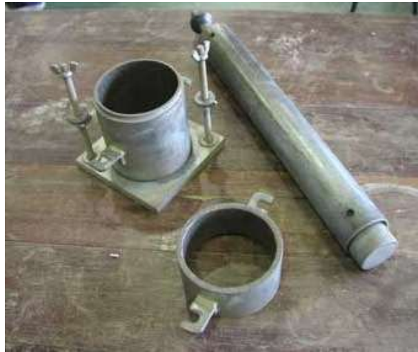
รูปที่ 3-25 อุปกรณ์หลักที่ใช้ในการทดสอบการบดอัด
