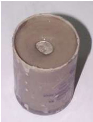
รูปที่ 2-20 เมื่อทิ้งไว้โดยไม่มีรบกวนจะมี Shear Strength เพิ่มขึ้นแต่เมื่อเขย่าหรือกวนกำลังจะลดลงจนกระทั่งไหลได้
