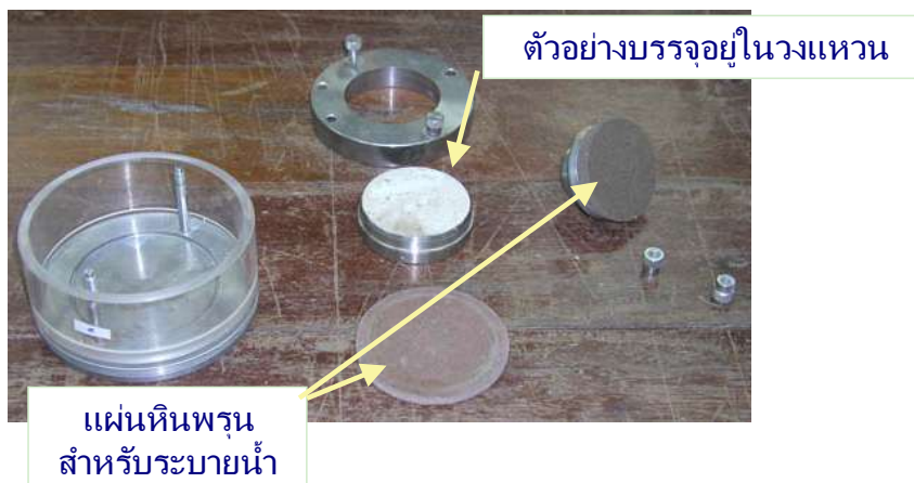
รูปที่ 7-15 อุปกรณ์ทดสอบการอัดตัวคายน้ำ
