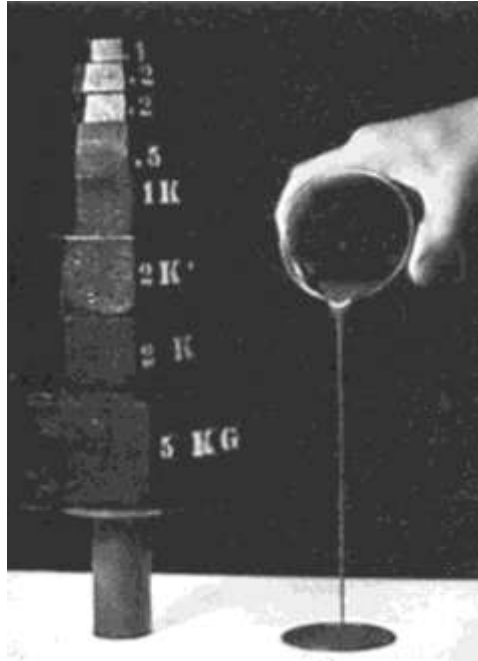
รูปที่ 7-71 ผลของการถูกรบกวนของตัวอย่างดินเหนียวที่มีความไวตัวสูง
