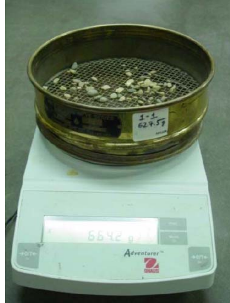
รูปที่ 4.1 ตะแกรงร่อนขนาดต่างๆ และขั้นตอนการทดสอบหาขนาดเม็ดของวัสดุ
