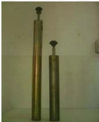
รูปที่ 5.2 ค้อนบดอัดแบบมาตรฐานและแบบสูงกว่ามาตรฐาน
