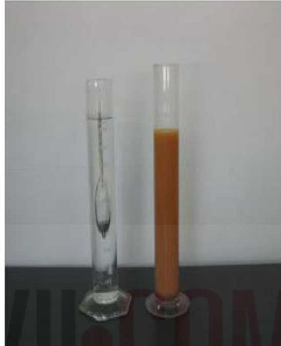
(b) การเก็บไฮโดรมิเตอร์ในขณะรอเวลาทดสอบ
