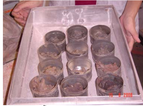
กระป๋อง+ดินชั้น ก่อนเข้าเตาอบ
