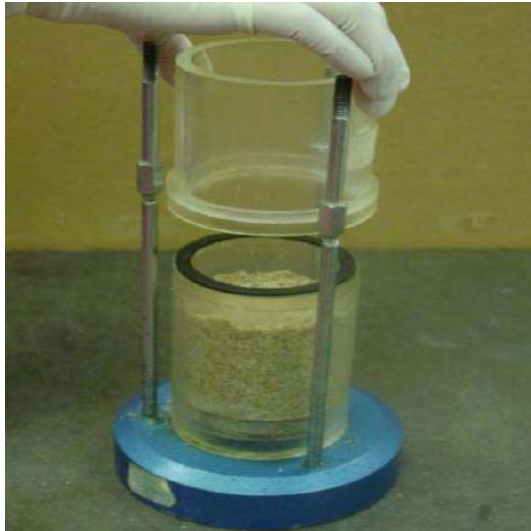
รูปที่ 3.2 การเตรียมตัวอย่างสำหรับการทดสอบการซึมผ่านได้ในดินโดยวิธีประเภทควบคุมระดับน้ำคงที่
