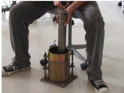
รูปที่ 5.10 ใช้ค้อนบดอัดดิน
