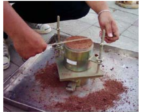
รูปที่ 5.11 ปาดดินที่เกินขอบ Mold ออก
