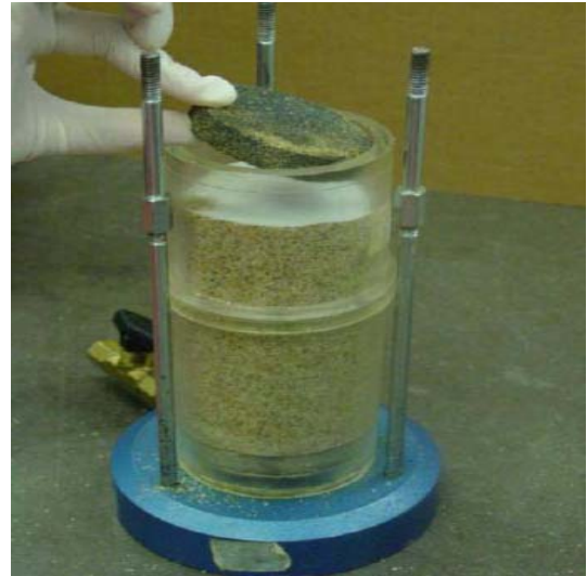
รูปที่ 3.2 การเตรียมตัวอย่างสำหรับการทดสอบการซึมผ่านได้ในดินโดยวิธีประเภทควบคุมระดับน้ำคงที่
