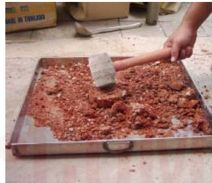
รูปที่ 5.13 ใช้ค้อนยางทุบก้อนดินที่เหลือให้แตกออกจนร่วน
