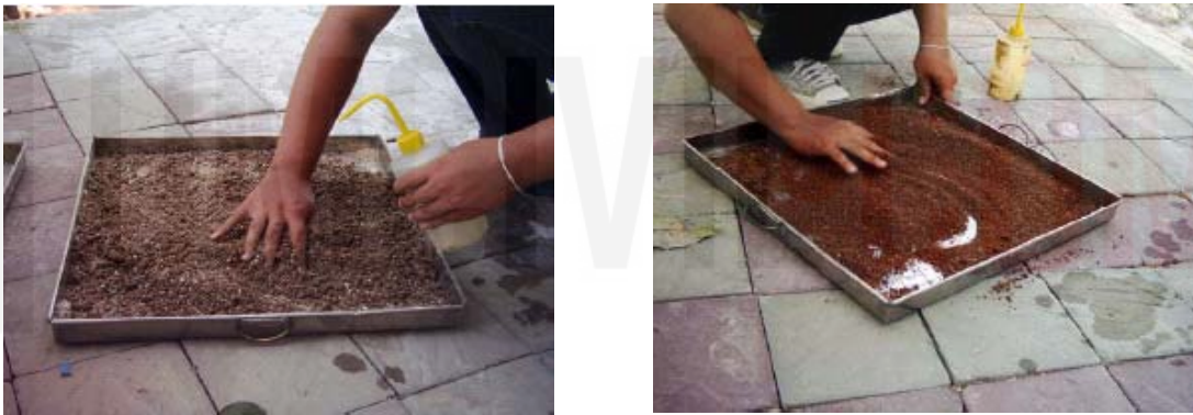
รูปที่ 5.8 นำตัวอย่างดินผสมน้ำให้มีความชื้นตามที่กำหนดและคลุกเคล้าให้เข้ากัน
