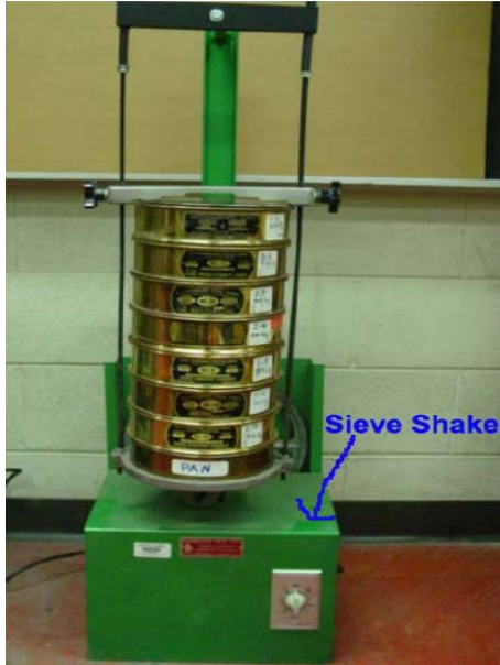
รูปที่ 4.1 ตะแกรงร่อนขนาดต่างๆ และขั้นตอนการทดสอบหาขนาดเม็ดของวัสดุ
