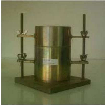
5.1a) แบบหล่อขนาดเส้นผ่าศูนย์กลาง 4 นิ้ว
