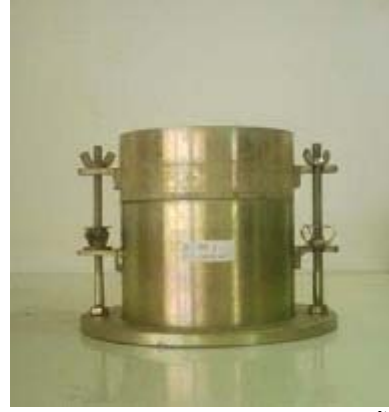
5.1b) แบบหล่อขนาดเส้นผ่าศูนย์กลาง 6 นิ้ว
