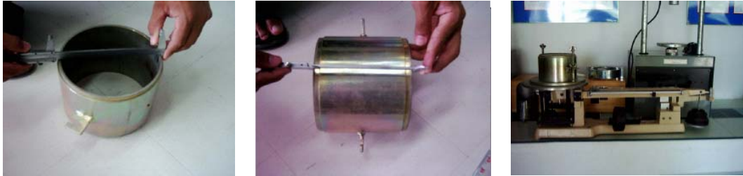
รูปที่ 5.7 วัดขนาดเส้นผ่าศูนย์กลาง ความสูง และชั่งน้ำหนัก
