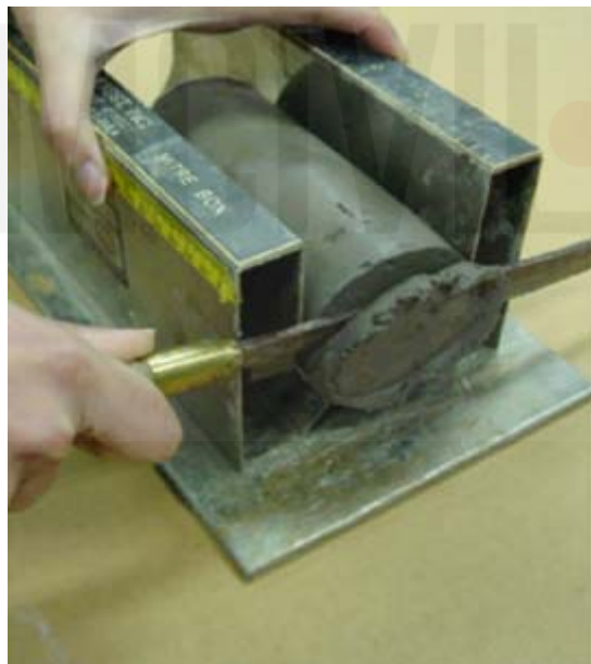
รูปที่ 3.1 การเตรียมตัวอย่างดิน และการทดสอบเพื่อหาค่าแรงอัดแกนเดียว
