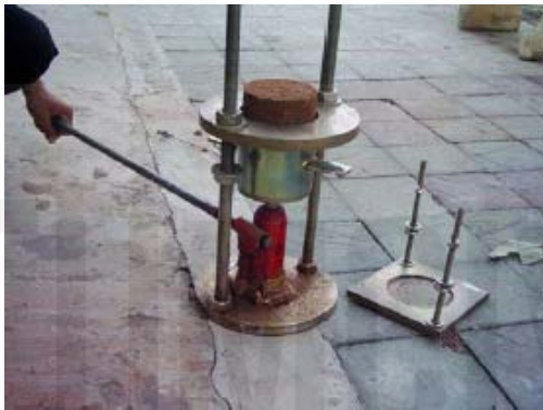
รูปที่ 5.12 ดันแท่งตัวอย่างดินออกจาก Mold
