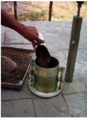
รูปที่ 5.9 ตักดินใส่ Mold
