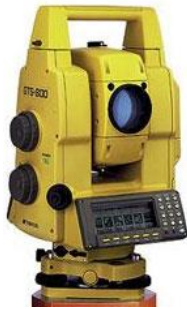
รูปที่ 5.13 กล้องวัดมุม Electronic Tacheometer
