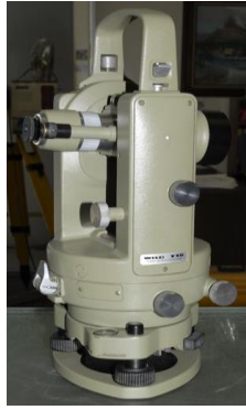
รูปที่ 5.6 กล้องวัดมุม Direct Reading Theodolite กล้อง Wild T16
