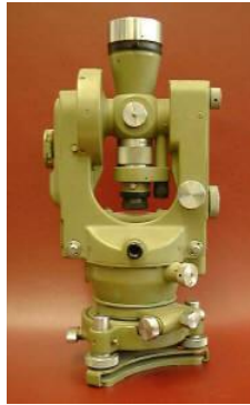
รูปที่ 5.7 กล้องวัดมุม Micrometer Theodolite กล้อง WILDT1
