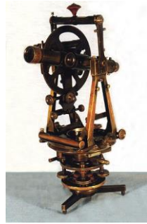
รูปที่ 5.9 กล้องวัดมุม Double Axis Theodolite เป็นกล้องชนิด Vernier
