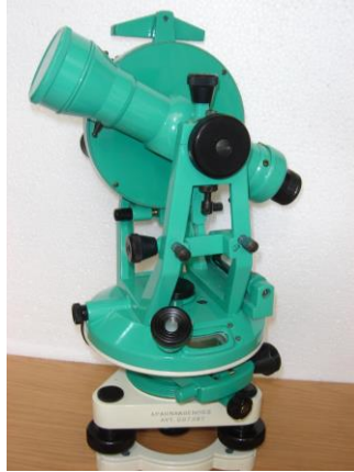
รูปที่ 5.4 กล้องวัดมุมแบบ Vernier
