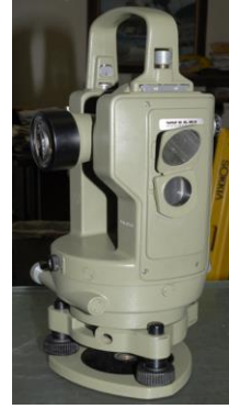
รูปที่ 5.6 กล้องวัดมุม Direct Reading Theodolite กล้อง Wild T16
